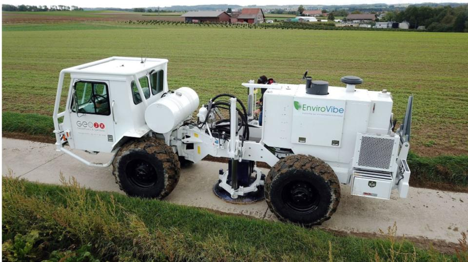
Sous le camion, on décèle la plaque qui permettra d'envoyer des vibrations. Photo: EnergieÔ
